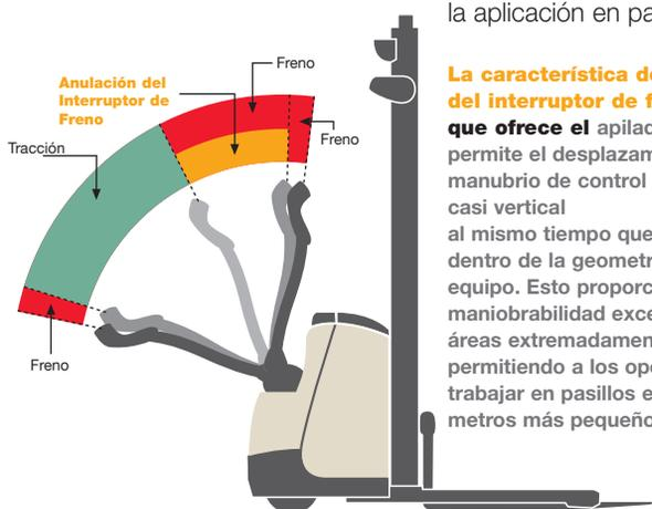
**La característica de anulación del interruptor de freno que ofrece el apilador ST/SX permite el desplazamiento con el manubrio de control en posición casi vertical al mismo tiempo que queda dentro de la geometría del equipo. Esto proporciona maniobrabilidad excepcional en áreas extremadamente reducidas, permitiendo a los operadores trabajar en pasillos entre 0.6 y 0.9 metros más pequeños.**
