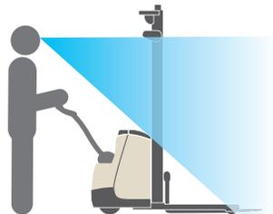
La inclinación de la cubierta de la unidad de potencia de perfil bajo y el diseño del mástil claro proporciona visibilidad excelente de la punta de las horquillas.
